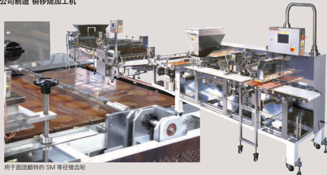
控制装置上使用了 SM 系列等径锥齿轮和 PM 塑料等径锥齿轮
